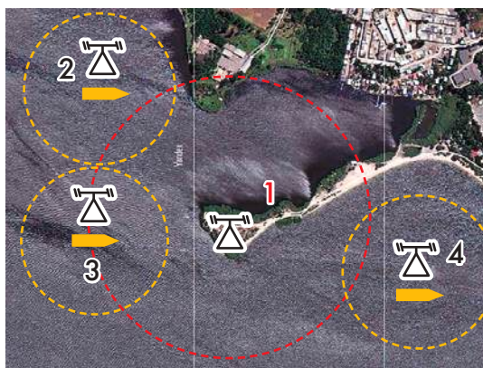
Рис. 2. Схема размещения секторных антенн, где: 1 — двухдиапазонная РЛС с круговой диаграммой направленности;
