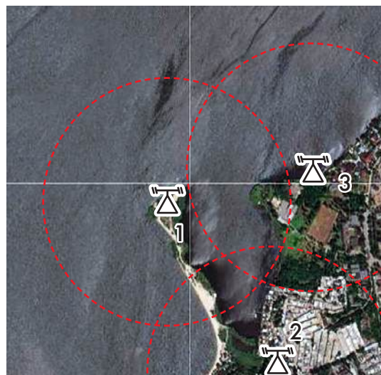
Рис. 3. Схема размещения РЛС для обнаружения и сопровождения БВС, где: 1–3 — РЛС для обнаружения БВС
