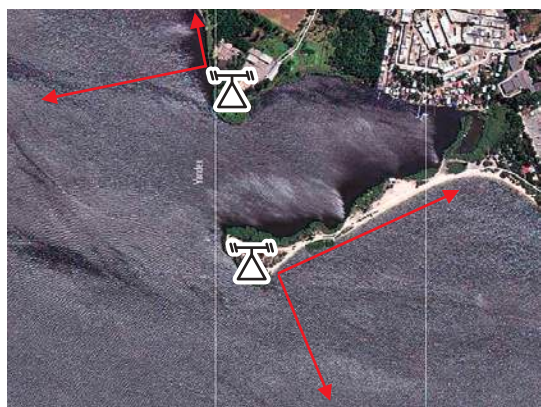
Рис. 1. Схема размещения секторных антенн для контроля объектов при движении вдоль береговой линии Условные обозначения:
